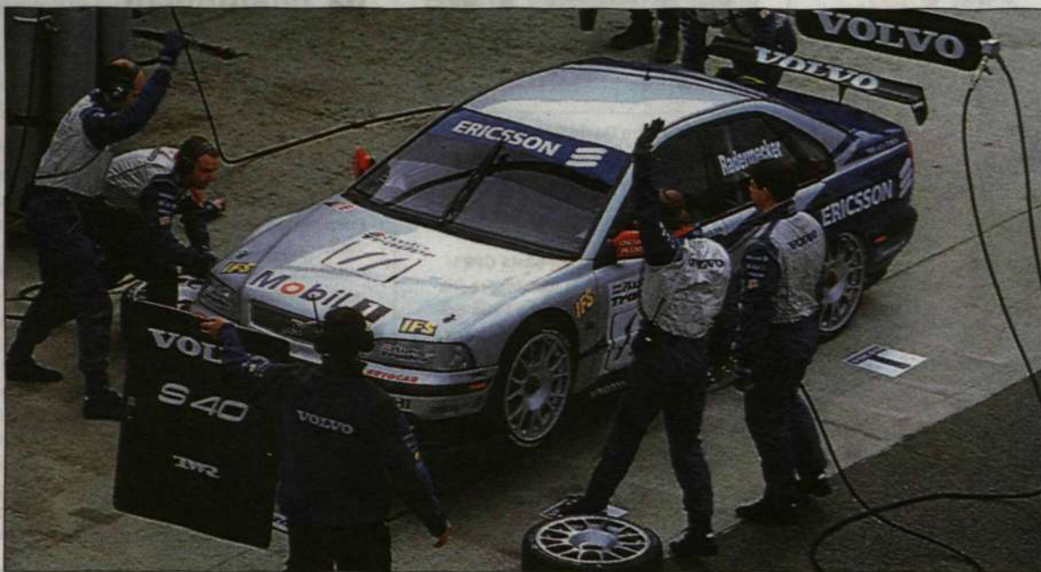
Med sponsringen av Volvos S40 Racing får Ericsson en unik möjlighet att testa utrustning för mobil data med GSM. När bilen kommer in för service, har teknikerna redan via GSM fått reda på vad som är fel.
