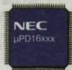
LCD IC Controller och drivare för segment, tecken och grafiska LCD.
