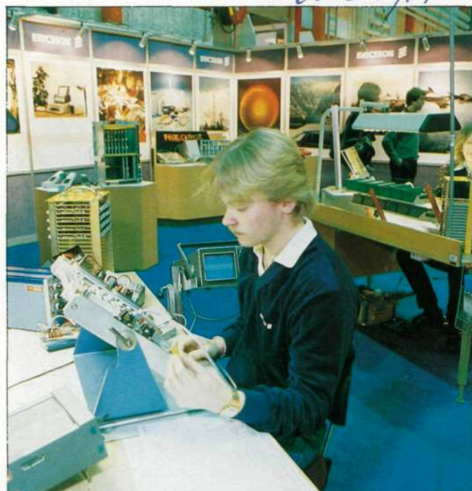
Så här går det till... LME-lärlingen Tony Jansander jobbar med bänkprovning av kretskort i Ericssonmontern på utställningen.
