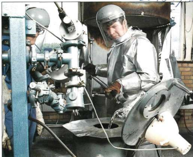
3. Kent håller smälten i degeln. Locket stängs, vacuum pumpen suger ut all luft och Per håller med hjälp av en spak smältan från degeln ner i gipsformen.
