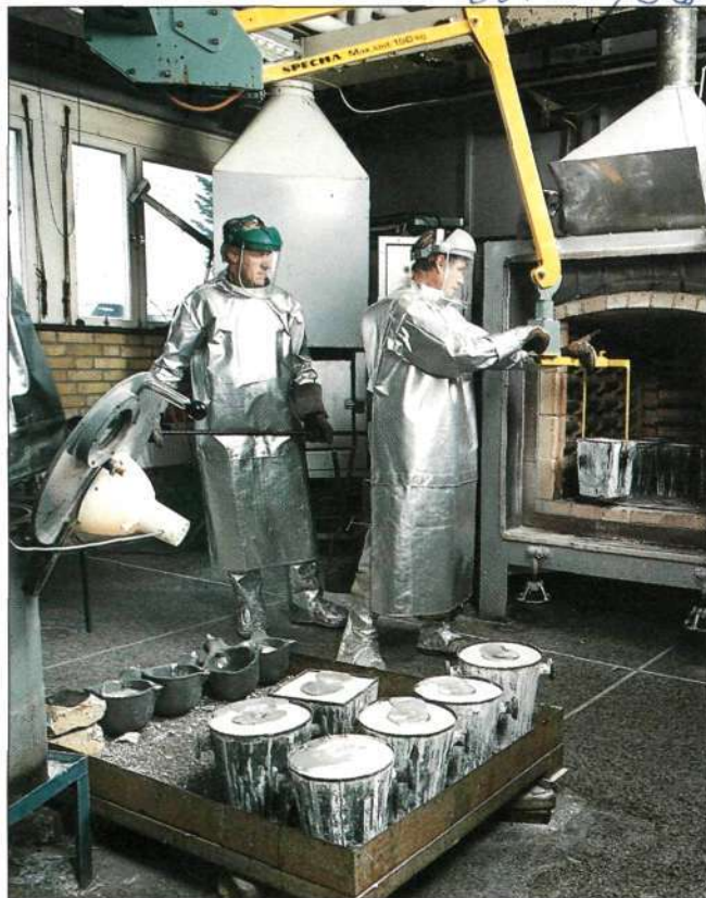
1. Kent lyfter gipsformen ur den 500-gradiga ugnen och placerar den i vacuumbehållaren längst till vänster. Roland står beredd med degeln.
