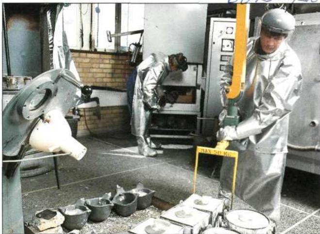
4. Kent lyfter ned den fyllda gipsformen, och Roland har redan börjat plocka fram degeln för nästa gipsform.
