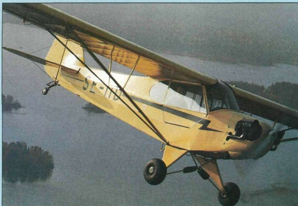
Planet ovan är en Piper Cub (J3), som är ett lätt 2-sitsigt plan, vanligen med en 90 HK motor.
