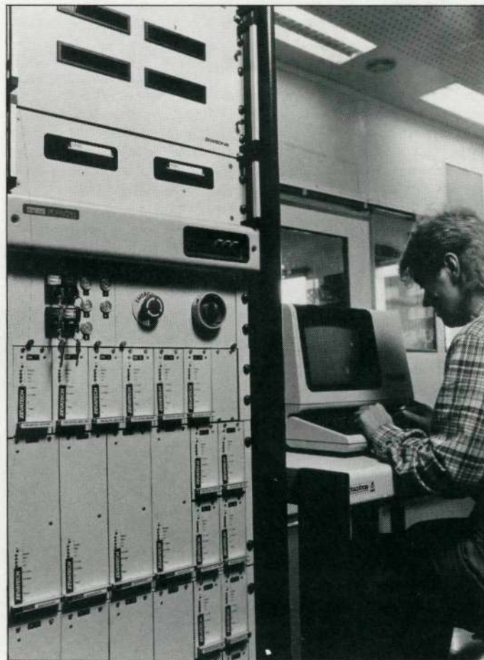
Kristina Pettersson programmerar in arbetsmomenten till de fem stationerna. I förgrunden syns maskinens "hjärna", en dator vilken styr alla funktioner.
