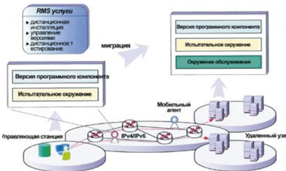
Рис. 4. Концепт работы системы RMS
