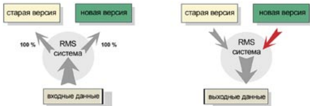
Рис. 5. Параллельная работа версий программного компонента
