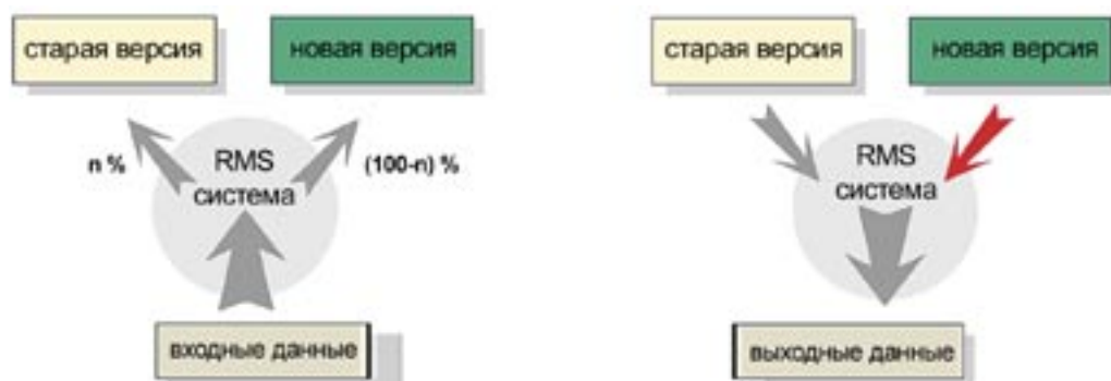
Рис. 6. Выборочная работа версий программного компонента
