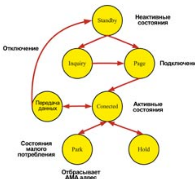
Рис. 4. Действия устройства Bluetooth в сети
